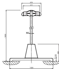
Betonsockel mit VOLANT-PLUS
